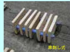
写真3 基盤の吊り下げ方法
