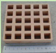
写真4 着床具 (寸法117×117×25mm、25個の15×15mmの孔付き)
