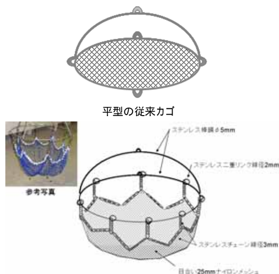
岩盤の凹凸に馴染むようにした改良カゴ
